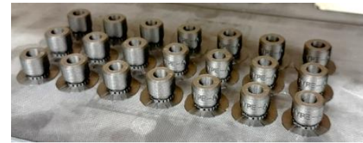
カーボンケブラー材を使用した3Dプリンタによる治工具(センターピン)
